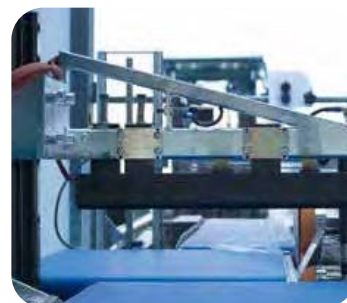
Ρυθμιζόμενος κεντρικός ιμάντας. Τα προϊόντα κινούνται πάντα στο κέντρο αυτού.
